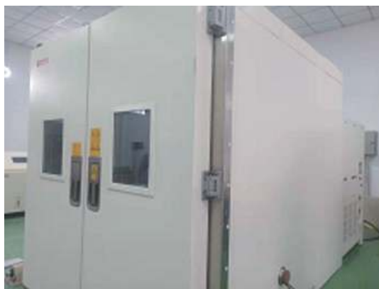
图 2 SDJ69AF 型温湿度实验箱 (-60℃~100℃)
