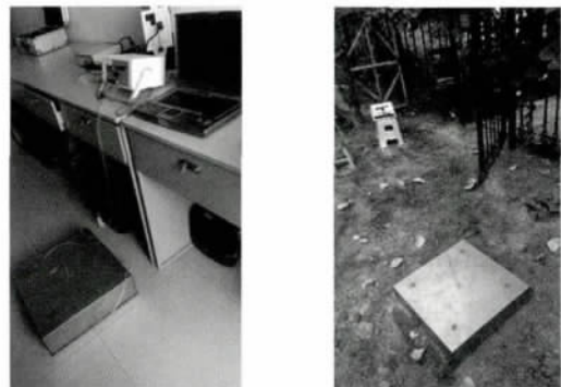
图 1 地瓷砖表面氡析出率测量 图 2 土壤表面氡析出率测量
