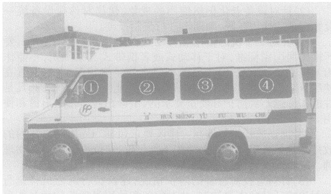
图 1 车载变频式 X 射线机车外观及车窗玻璃布点位置
