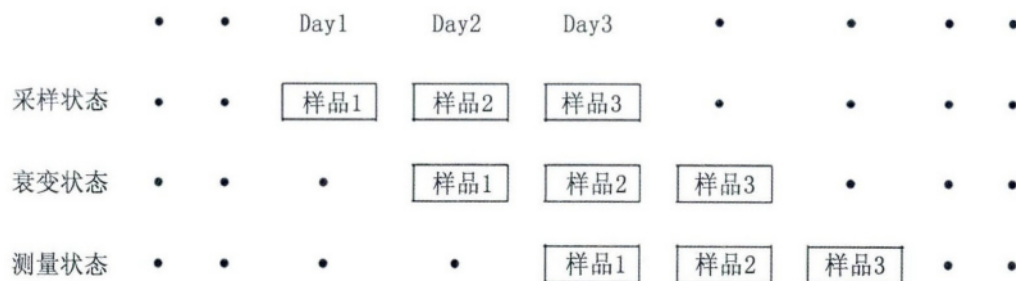
图1 大气放射性核素连续流程示意图
